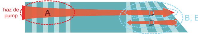
Figura 3.21: Esquema de la reflexión del haz de bombeo en la superficie muestra/aire. El grosor decreciente de la flecha que simboliza al haz emula cualitativamente la absorción de la luz en la muestra. La elipse roja indica la región de la muestra en la que la integral (3.9) devuelve el pico en la función de detección correspondientes al modo de q = 0 de la superred uniforme, denotado con la letra A en la Fig. 3.22. En la región de la superred con gradiente las elipses celestes pequeñas destacan las componentes del campo eléctrico que dan los modos de q = 0 de la superred de sondeo al incluir los dos primeros términos de la ec. (3.11) en la integral (3.9). Este modo se indica con la letra D en la Fig. 3.22. La elipse celeste de mayor tamaño encierra los haces cuya interferencia resulta en los términos tercero y cuarto de la expresión (3.11), los cuales, al ser reemplazados en (3.9), hacen que la función de generación resulte sensible al doblete de q = 2k_b de la superred con gradiente.
