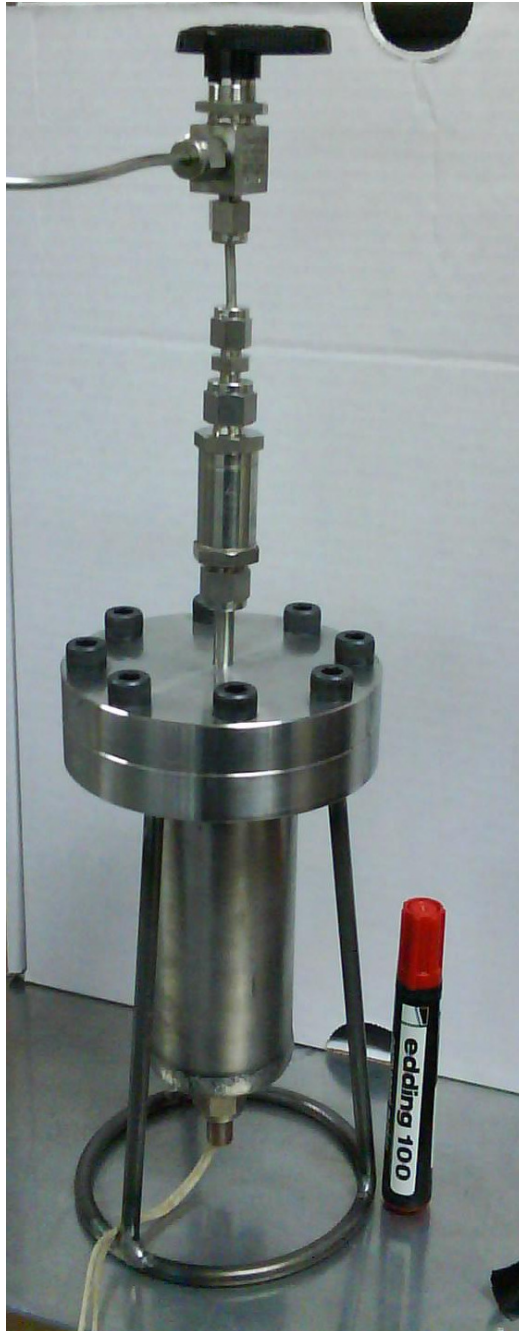
Figura 3-16: Fotografía de la fuente armada, con un marcador al lado como referencia de tamaño. A la salida de la fuente hay un filtro para evitar la pérdida de MFH, y a continuación una válvula esférica. Los cables que salen del tubo de cobre corresponden al calefactor.
