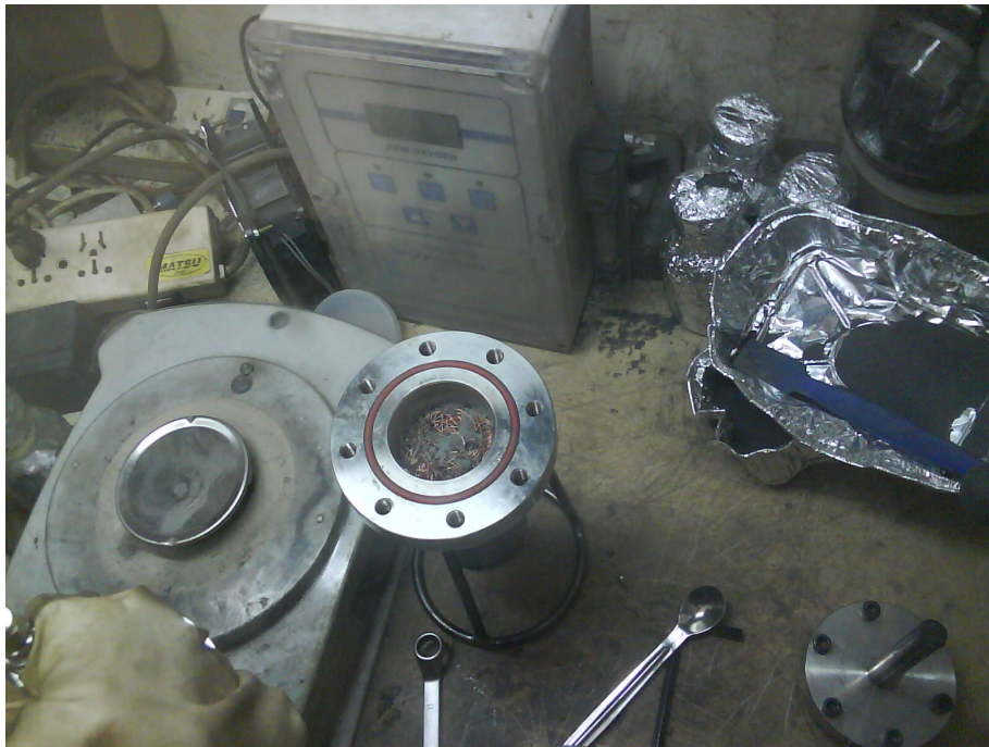
Figura 3-19: Fotografía de la fuente, al cargarle el LaNi 5 y los alambres de cobre. La fuente está en el interior de una caja de guantes, bajo atmósfera de argón.
