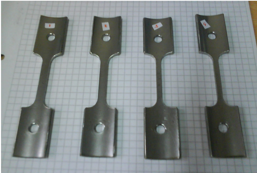
Figura 2-1: Foto de las probetas para el ensayo de tracción, realizadas con el mismo material que utilizamos para construir la fuente. El cuadrículado de fondo es de 5 mm de lado.
