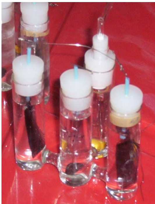
Figura 3.6. Esquema y foto de una de las celdas electroquímicas utilizadas en este trabajo.
