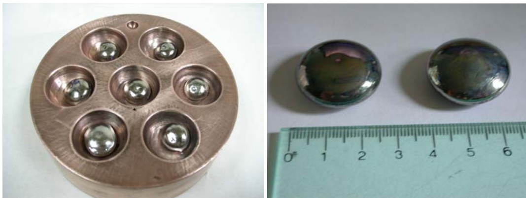
Figura 3.2. Crisol de Cobre y botones obtenidos por fundición en el horno de arco.
