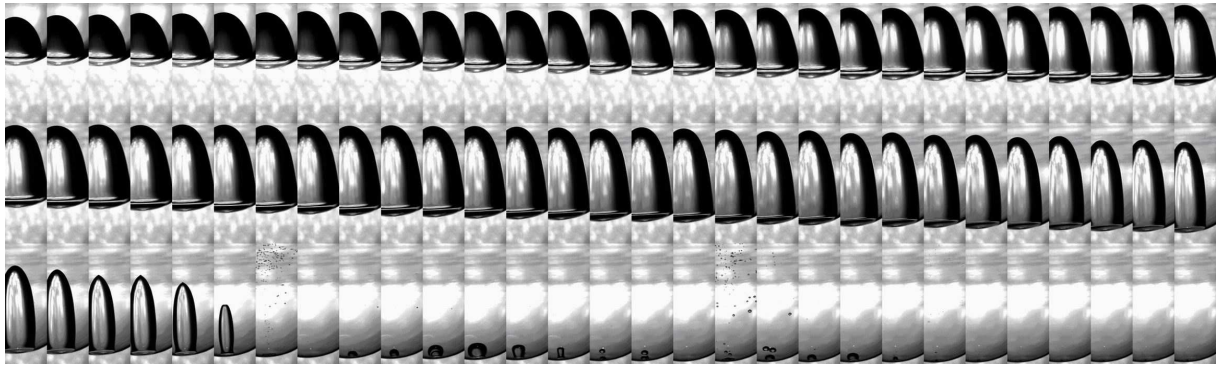
Figura 10.11: Secuencia de imágenes de la burbuja inferior en el martillo líquido en el momento del colapso con el tubo girando a una velocidad de \sim 33Hz y una excitación vertical de 16.55Hz . En este caso las fotos están separadas un tiempo equivalente de 315\mu s/foto . La altura de una imagen individual corresponde a 15,5mm . La secuencia completa de fotos muestra aproximadamente la mitad de un período.
