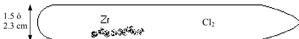
Figura 3.1. Esquema de reactor tipo I. Las virutas de circonio se hallan en contacto con la pared de cuarzo del reactor.
